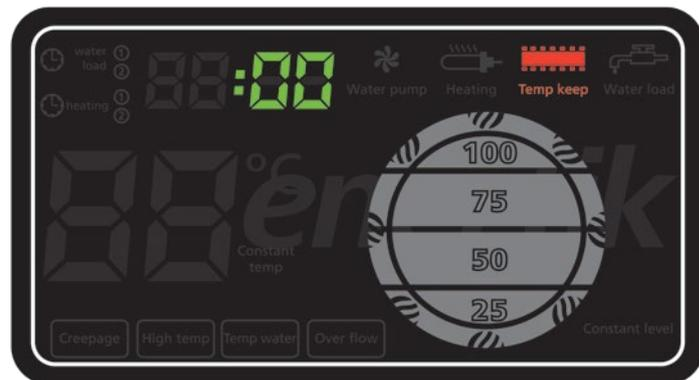
**4 5** Presionar **SET** cuatro y cinco veces desde **inicio** para acceder a los parámetros del tiempo de encendido y apagado del llenado programado **WATER LOAD (1)** y **WATER LOAD (2)**. Fijar ambos tiempos en 00:00 si de desea operar en modo automático básico.
