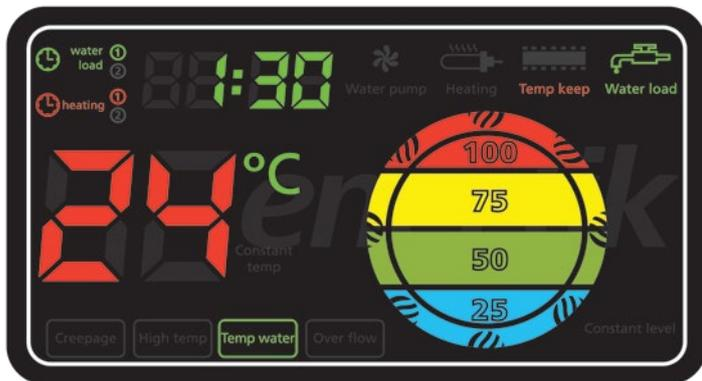
**1** Presionar **SET** una vez para acceder a los parámetros de temperatura mínima del sistema. Con ▲ y ▼ se selecciona de a 5 grados el valor a partir del cual queremos que se encienda el kit de calefacción. Por debajo del valor programado, se encenderá la resistencia para calentar el agua del estanque hasta el valor indicado. **Rango seleccionable: 30~80°C**
