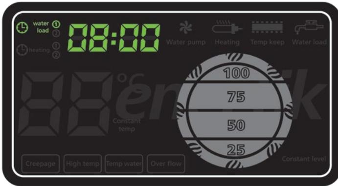
**6 7** Presionar **SET** seis y siete veces desde **inicio** para acceder a los parámetros del tiempo de encendido y apagado de la resistencia de calefacción **HEATING (1)** y **HEATING (2)**. Fijar ambos tiempos en 00:00 si de desea operar en modo automático básico.
